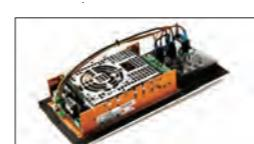
V1212P采用D类功放能有效输出750Wx2正弦波等级的强大功率具有THD<0.01超低失真。电源开关采用可恢复的液压空气开关作为有效保护，在极端的盛夏季节也无需担心过热，尽管放心使用。
